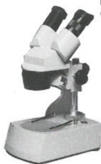
EUROMEX Stereomikroskop KTD Vergrößerung 20x und 40x
