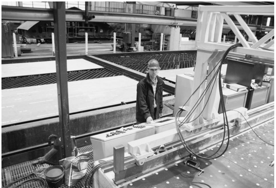
Abb. 2: Einsatz eines optischen Messsystems im Schiffbau (FSG Flensburg)
