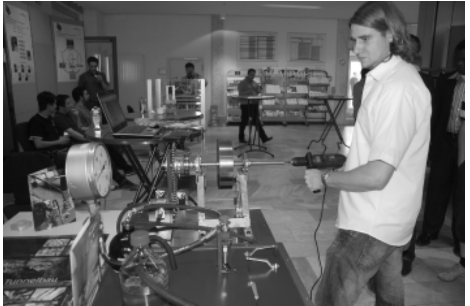
Lukas Derksen führt das hydraulische Bremsenergie-Rückgewinnungssystem vor.
