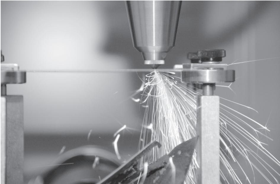
Abb. 1: Einsatz von Hochleistungslasern zur Materialbearbeitung bei der studentischen Ausbildung im LFM. Hier: Laserschneiden von Edelstahlblech mit hoher Qualität. Alle Abbildungen: Klaus Dickmann
