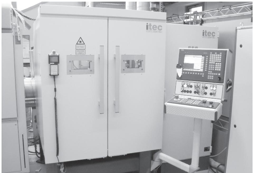
Abb. 2: Hochleistungslaser der Klasse 4 wird durch vollständige Einhausung in Kombination mit weiteren technischen Schutzmaßnahmen in die sichere Klasse 1 eingestuft.
